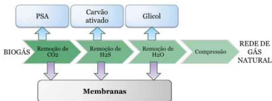
Figura 05: Diagrama com as operações necessárias para utilização do biogás (HABERT, 2006)
