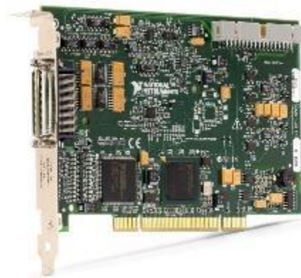
Figura 10: Placa PCI 6229; b) Módulo SCB-68
