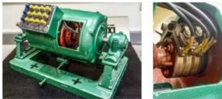
Figura 3: a) Máquina de indução trifásica de rotor bobinado; b) escovas da máquina.
