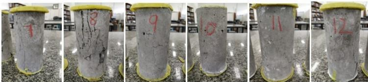
FIGURA 1. Corpos de prova após primeiro ensaio de ruptura
