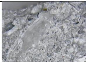
**Figura 4.** Microscopia óptica com aumento de 50x para 5%. Ênfase no agregado de PET
